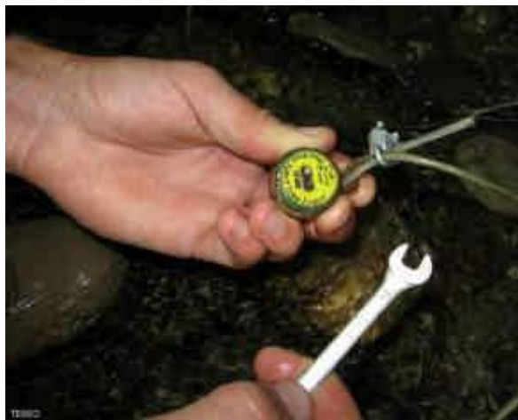
Mise en place d'une sonde Tidbit
