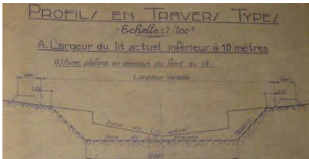
Extrait des plans de travaux lors du recalibrage de la Reyssouze (1956)
